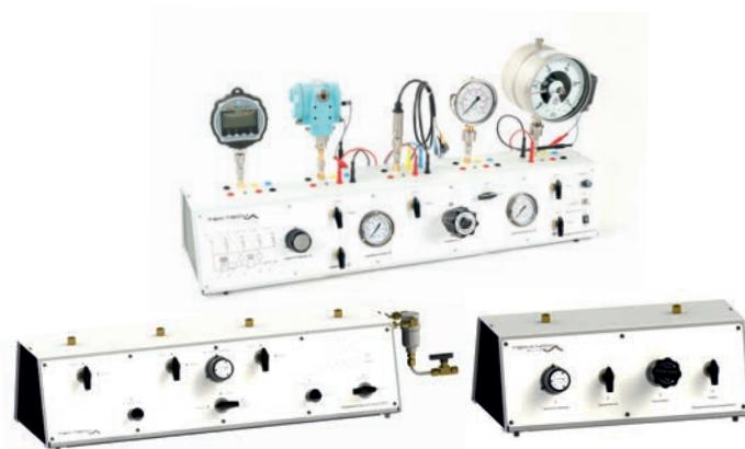
Рис. 4. Пневматические стойки для регулирования давления
