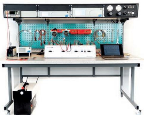
Рис. 2 Автоматизированный стенд для поверки/калибровки/ремонта приборов давления
