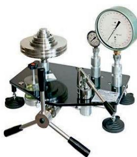
Предназначен для поверки и калибровки средств измерений избыточного давления: измерительных преобразователей давления (датчиков), образцовых и технических манометров, классов точности 0,075 и грубее в диапазоне от 0,04 до 60 МПа.
