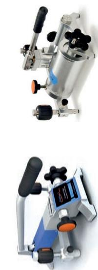
Высококачественные помпы (прессы) с тонкой настройкой давления. Для поддержания стабильного давления в процессе калибровки/проверки , помпы серии ADT сконструированы таким образом, чтобы нивелировать влияние температуры внешней среды. Специально разработанный запорный клапан помп позволяет поддерживать стабильное давление на всем протяжении процедуры калибровки/проверки.
