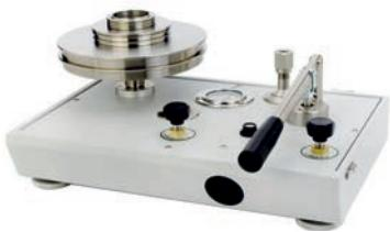
Предназначены для калибровки практически всех приборов для измерения давления, включая датчики, шкальные и бесшкальные манометры, а также реле давления. Предназначены для использования в лабораторных условиях.
