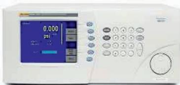
**Задание и измерение абсолютного и избыточного давления при проведении поверки и калибровки средств измерения давления. Применяются в лабораторных условиях в качестве эталонов единиц давления.**
